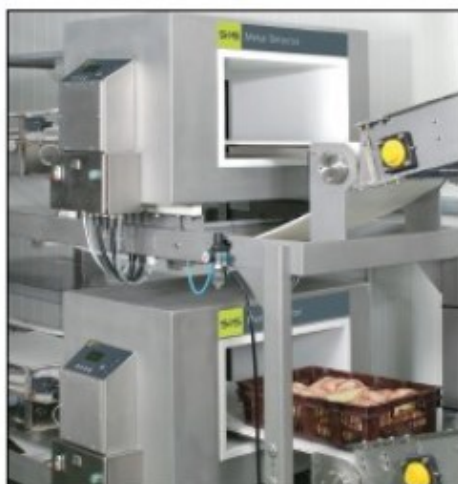
Detector de metales GLS instalado en dos líneas de producción para la inspección de aves
